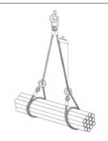
Brache a fune di acciaio per usi generali nel sollevamento: gruppo di componenti che include uno o più bracci singoli o una braca ad anello continuo destinata a una varietà di operazioni di sollevamento e non progettata per un'applicazione di sollevamento specifica [EN 13414-1].
