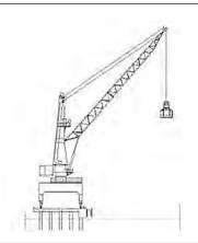
**Gru a braccio rotante:** gru motorizzata progettata per installazione permanente, montata in postazione fissa o libera di traslare su rotaie orizzontali, dotata di un braccio che può ruotare intorno all'asse verticale [EN14985].
