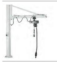
**Gru a bandiera del tipo a colonna**: gru in grado di ruotare su un pilastro fissato alla base di una fondazione, o fissata ad un pilastro che può ruotare nella sua fondazione [ISO 4306].
