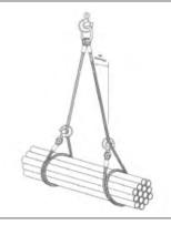
Brache a fune di acciaio per usi generali nel sollevamento: gruppo di componenti che include uno o più bracci singoli o una braca ad anello continuo destinata a una varietà di operazioni di sollevamento e non progettata per un'applicazione di sollevamento specifica [EN 13414-1].
