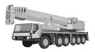
**Autogru**: gru a braccio autonomo in grado di spostarsi con o senza carico senza la necessità di vie di corsa fisse e che si basa sulla gravità per la stabilità. Tali gru possono funzionare su pneumatici, cingoli o altri mezzi mobili. In posizioni fisse possono essere sostenute da stabilizzatori o altri accessori che ne aumentano la stabilità [EN 13000].
